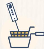
**Mesurer les composés polaires avec un Testo 270.** Un contrôle régulier évite de devoir changer l'huile de friture trop tôt ou trop tard.
